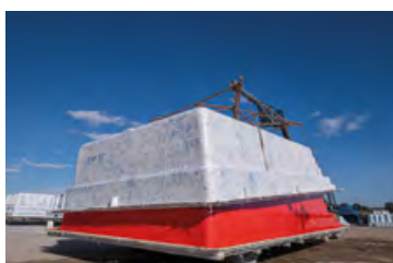
07. Desmoldado de la piscina
